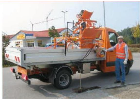
Der Sinkkastenreiniger ist ein leicht auswechselbares Zusatzgerät, passend für fast alle Kommunalfahrzeuge.
