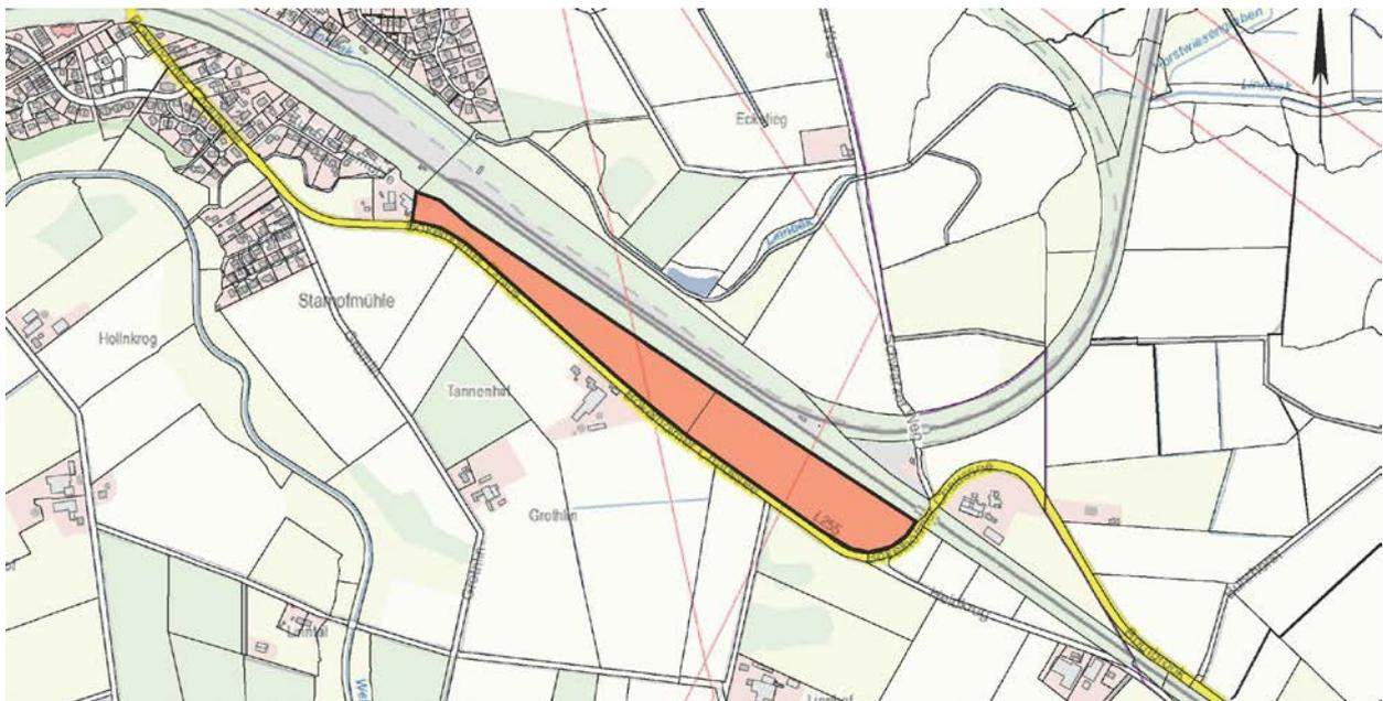
Der Investor plant eine einheitliche Freiflächenanlage mit ca. 23.000 Modulen mit je 260 Watt Leistung und einer Mindest-Betriebslaufzeit von 20 Jahren. Die Anlage wäre per Fernzugriff steuerbar. Der erzeugte Strom würde in das Netz der SH Netz AG eingespeist werden. Die in Anspruch genommenen Flächen würden im Eigentum des Grundstückseigentümers verbleiben und vom Investor gepachtet werden.
